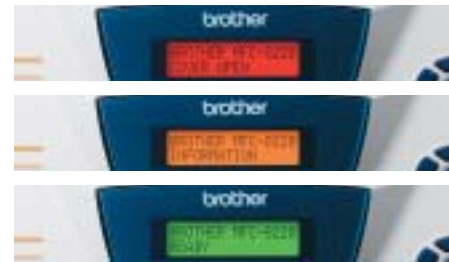
Pantalla LCD retroiluminada de 3 colores Para reconocer fácilmente el estado del equipo
